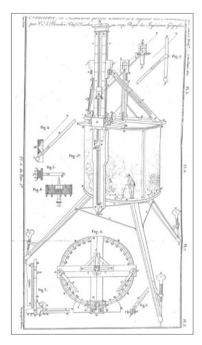
Fig. 4 "Panotrace, ou Instrument propre à tracer et à dessiner des Panoramas, par C.A. Boucher, Chef d'Escadron au corps Royal des Ingénieurs Géographes" Drawn by De Moléon. Annales de l'Industrie Manufacturière, Agricole et Commerciale de la salubrité publique et des Beaux-Arts 1 (1827), second plate.
